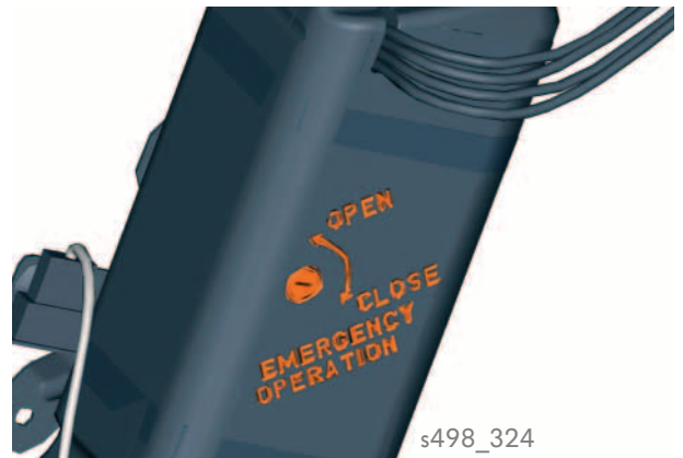
Notbetätigungsschraube und Hinweis zur Drehrichtung auf dem Gehäuse der Hydraulikpumpe für Verdeckbetätigung
